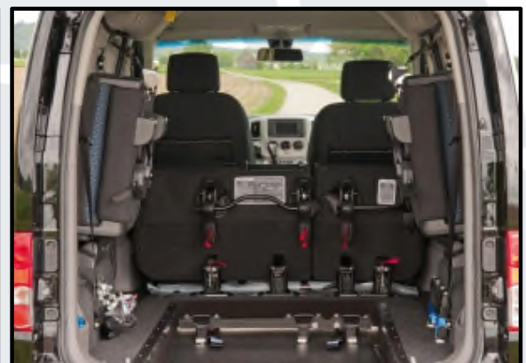
SIDILI POSTERIORI RIPIEGATI PER TRASPORTO CARROZZINA
