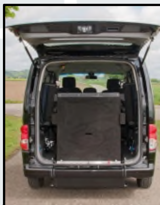
RAMPA DI CARICO CHIUSA
