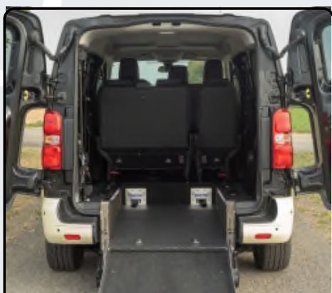
RAMPA DI ACCESSO APERTA
