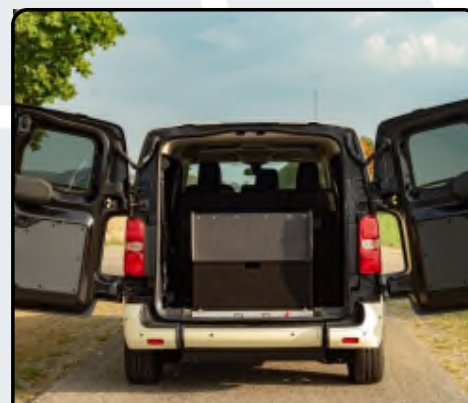
RAMPA DI ACCESSO CHIUSA
